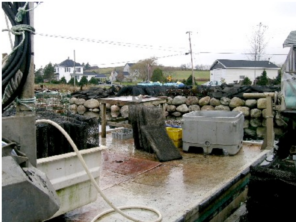
Photo 16b. Table de tri, vivier (blanc) et bassin de type X-actic (gris) disposés sur le pont du bateau de Lunenburg Shellfish Inc. Le tuyau maintient une circulation d'eau dans le vivier, grâce à une pompe installée sur le quai flottant, non visible sur la photo.
