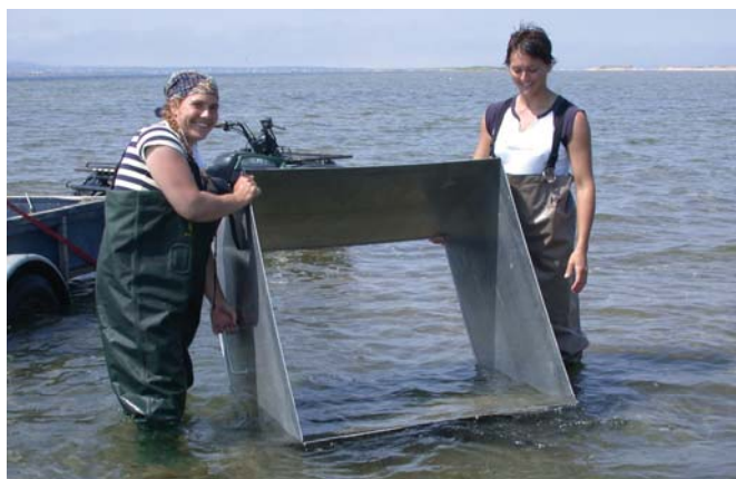
Photos 2 et 3. Cadre de métal utilisé pour réduire l'effet du courant et des vagues qui auraient pu nuire lors des ensemencements de petites myes en causant des déplacements.
