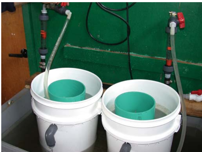
Photo 2. Upwellers fabriqués avec des cylindres en PVC et installés dans la salle des bassins du MAPAQ. Chaque silo contient environ 4 000 petites myes.
