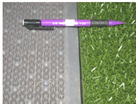
Photo 2 Tapis gris (à gauche) et tapis verts « Astro-Turf » (à droite) expérimentés pour le captage de myes.
