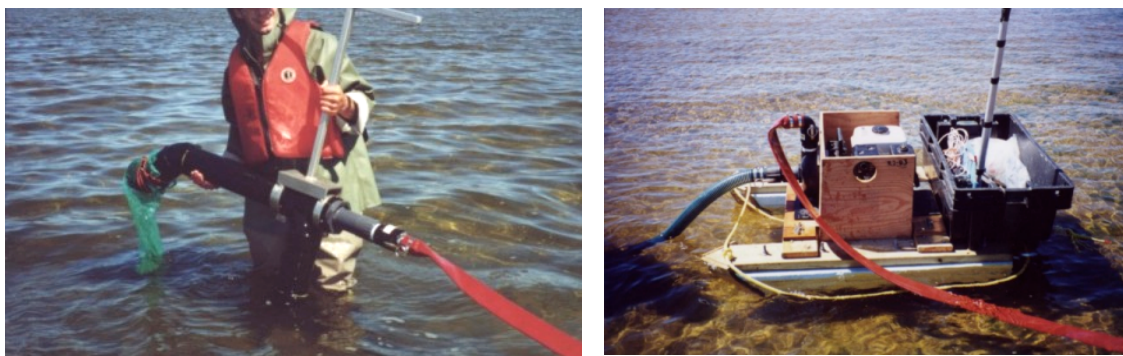
Photo 2. Système d'échantillonnage « Venturi » utilisé pour l'inventaire des myes (à gauche) et sa pompe à eau installée sur un radeau flottant (à droite).
