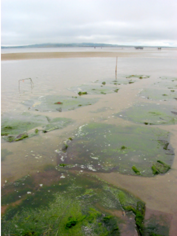
Photo 6 : Filets de captage benthique. Au centre gauche, on aperçoit aussi les tiges pour l'étude de la dynamique des sédiments.
