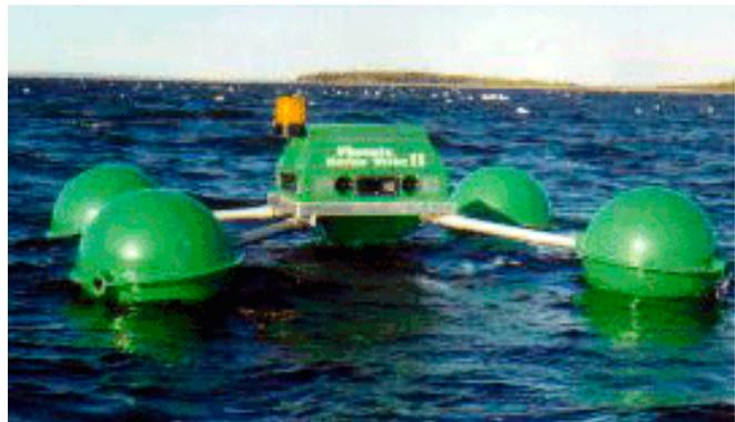
Figure 5. Marine Phoenix Wailer avec flotteurs intégrés.
