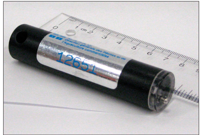
Figure 6. Vue rapprochée d'un enregistreur de température en continu de type Minilog
