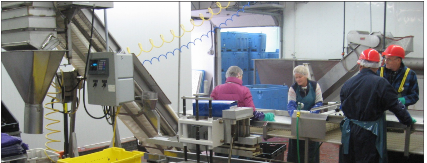
Figure 11. Illustration de la chaîne de traitement des moules fraîches dans l'entreprise Menu-Mer Itée. L'intervalle entre les bacs expérimentaux traités a été calculé pour bien individualiser les lots.
