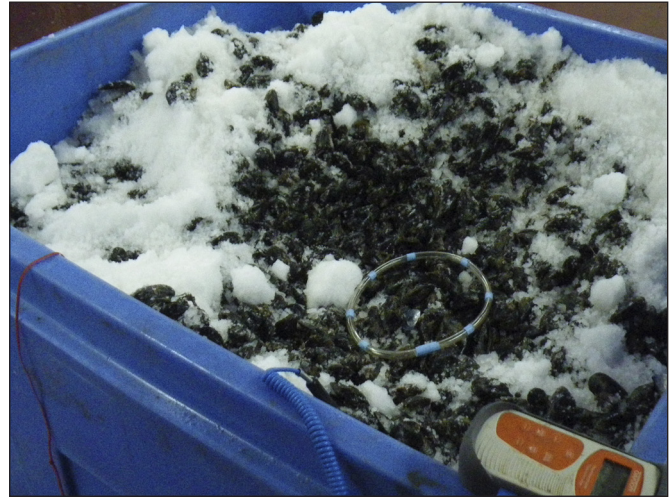
Figure 10. Exemple de disposition de l'anneau d'échantillonnage du bâillement de surface dans un bac.
