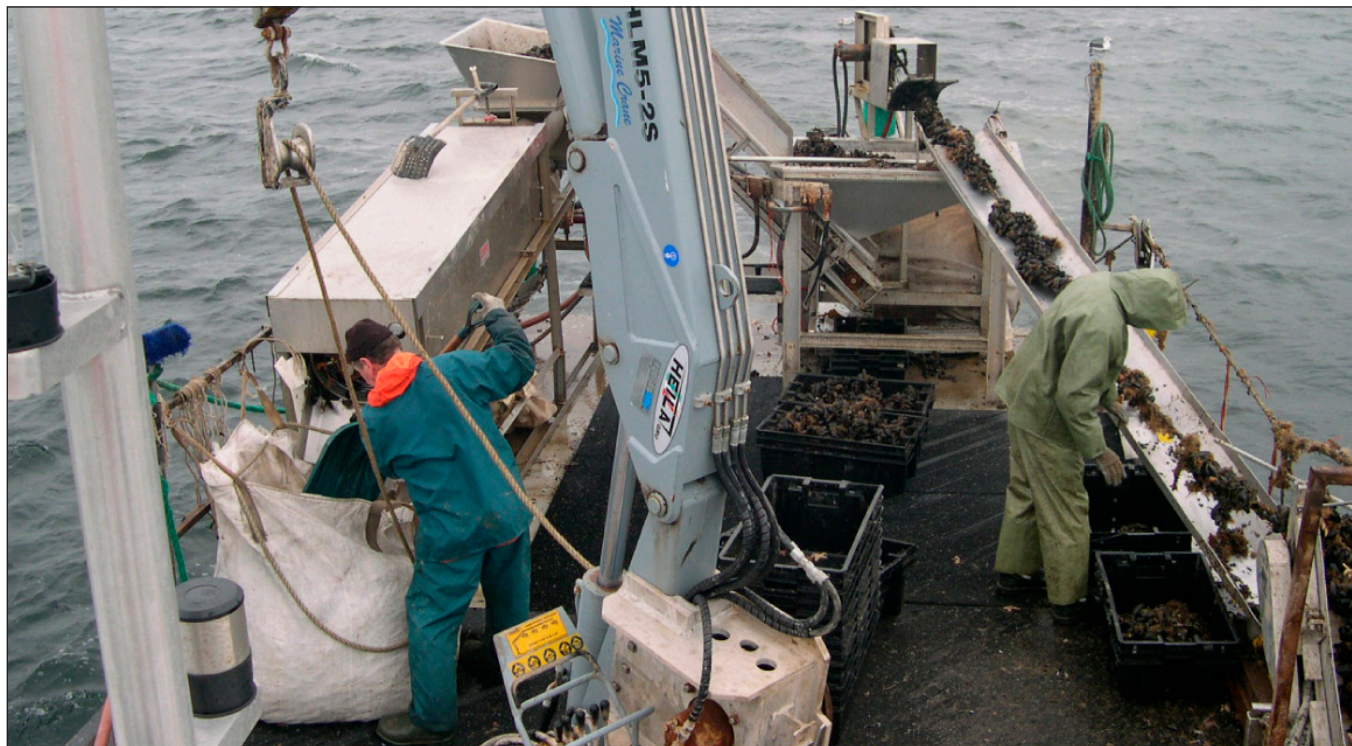
Figure 1a. Vue en plongée du système de récolte standard avec convoyeur et dégrappeuse-trieuse à bord du GRT.
