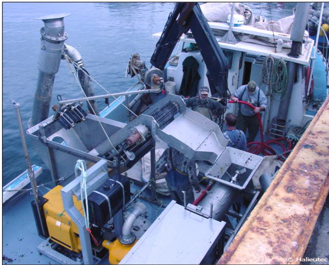
Figure 1b. Vue en plongée du système de récolte venturi à bord du GRT-Synchro (avec la permission de Halieutec).
