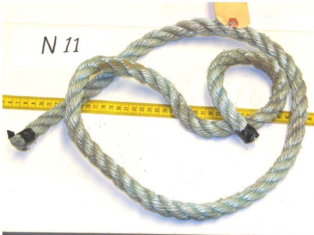
Cliché 4. Segment noué sur un pieu à hélice (Filière n° 3) - Cordage V1 de \frac{3}{4} po
