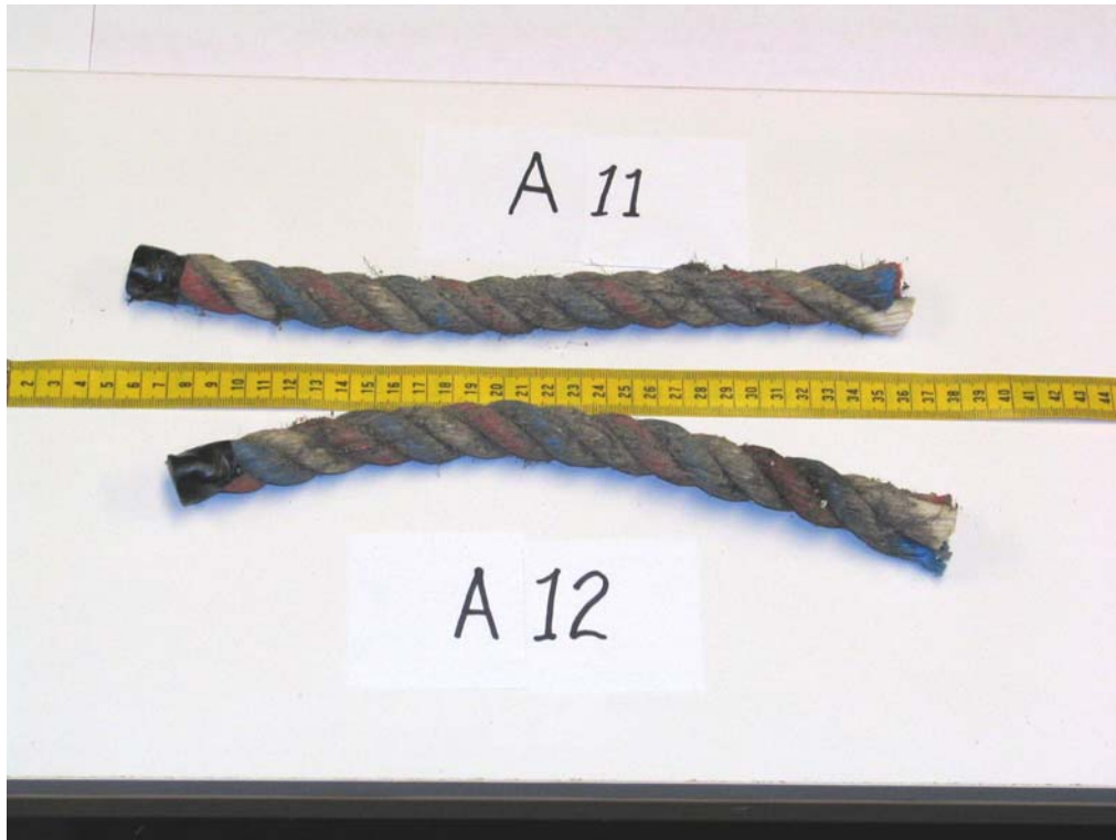
Cliché 1. Filière n° 167 - Segments A1 et A2 -Cordage BBR de \frac{7}{8} po
