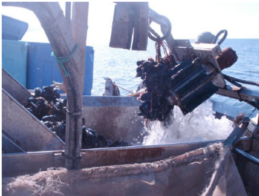
Figure 8. Brassage de l'eau dans la cuve du système de récolte Venturi.
