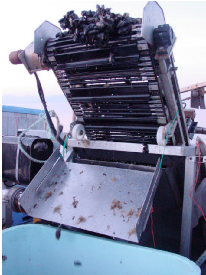
Figure A2. Photo du convoyeur-trieur à courroie associé au système Venturi, à bord d'un bateau de la compagnie les Moules Cascapédia ltée.
