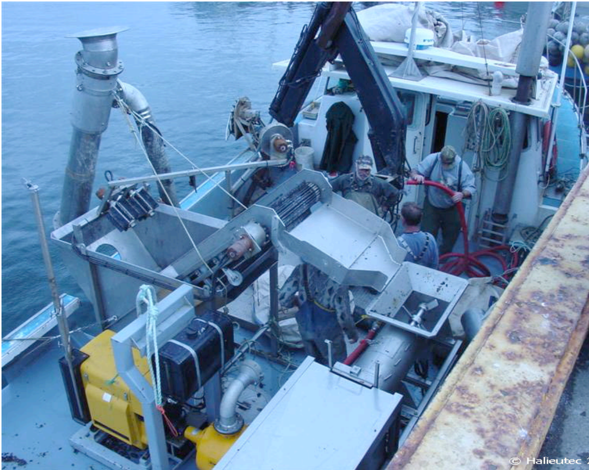
Figure A1. Photo de l'équipement de récolte Venturi à bord d'un bateau de la compagnie les Moules Cascapédia ltée. La dégrappeuse-trieuse à tambour n'a pas encore été retirée du pont du bateau.
