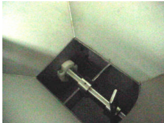
Photo 4 : Bac de l'égrappeuse et vis sans fin
