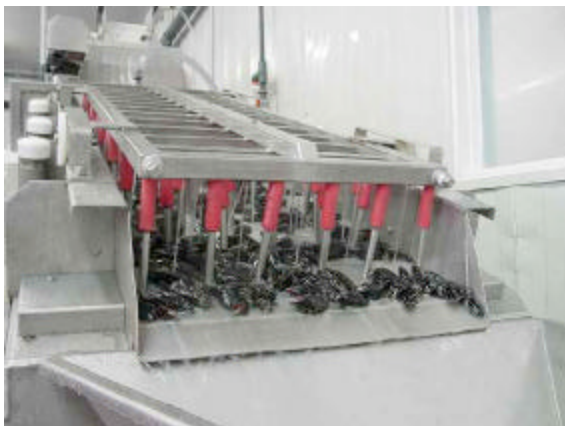
Photo 7 : Débysseuse vue du bas du plan incliné.
