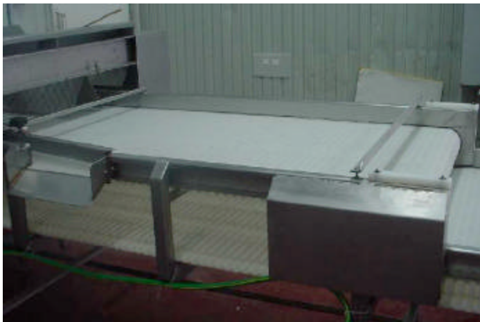
Photo 9 : Première table d'inspection (centre), avec la dérivation automatique pour les petites moules (gauche) et le début de la seconde table (droite).
