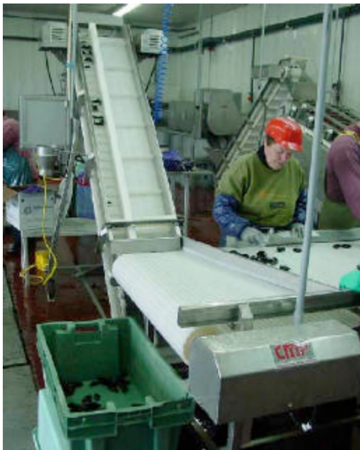
Photo 11 : Extrémité de la seconde d'inspection, dérivation vers l'ensachage, table panier de rejet des moules moribondes.
