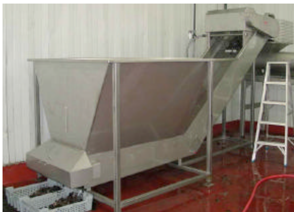
Photo 1 : Trémie de réception, vue générale
