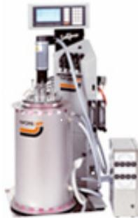
*Le Labfors Lux s'inspire des fermenteurs traditionnels de laboratoire utilisés pour la culture des bactéries et des champignons microscopiques (série Labfors3 d'Infors AG). Ce PBR est un fermenteur bench-scale de 2,4 litres de volume utile entouré de lumières lesquelles peuvent être contrôlées manuellement ou automatiquement.*
