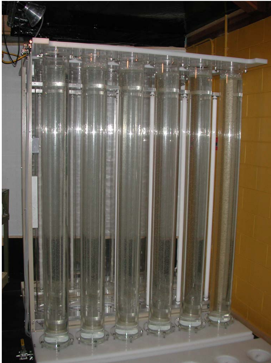
Figure 1. Le prototype pilote du photobioréacteur du PEPPA. Six cylindres d'acrylique en communication dans une base de polyéthylène. Le volume utile est de 260 litres.
