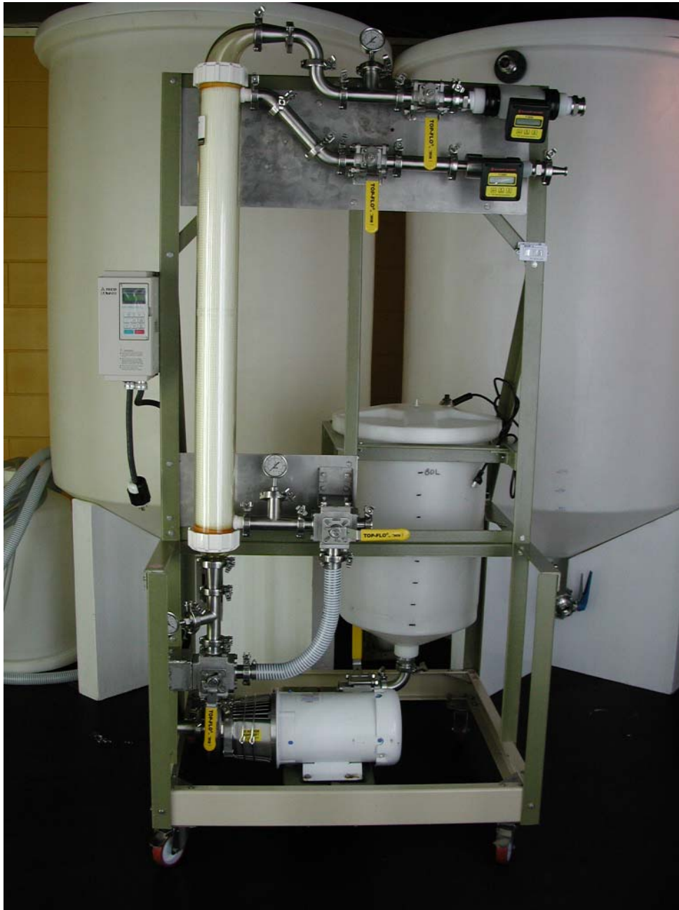
Figure 2. L'unité de traitement des liquides pour la préparation du milieu de culture. Une cartouche à membrane d'ultrafiltration à fibres creuses permet de réaliser la filtration et la stérilisation du milieu de culture en une seule étape.
