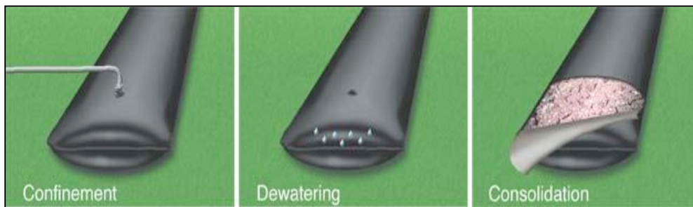
Figure 5.2 : Schématisation des étapes du procédé de déshydratation à l'aide de membranes géotextiles (Ten Cate, 2006)
